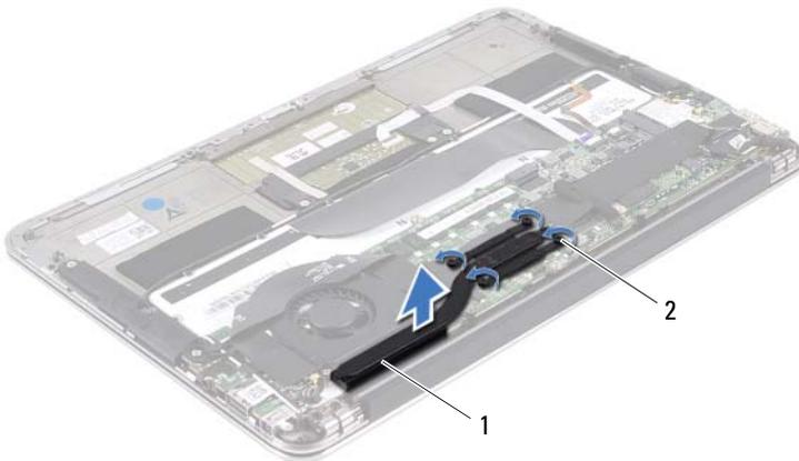
1 dissipatore di calore
